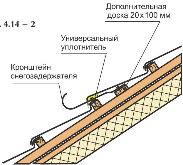
Структура материала MetroTile® препятствует лавинообразному сходу снега с кровли. В тех случаях, когда угол уклона кровли превышает 40° или строительные нормы требуют установки снегозадержателей, их возможно установить согласно
