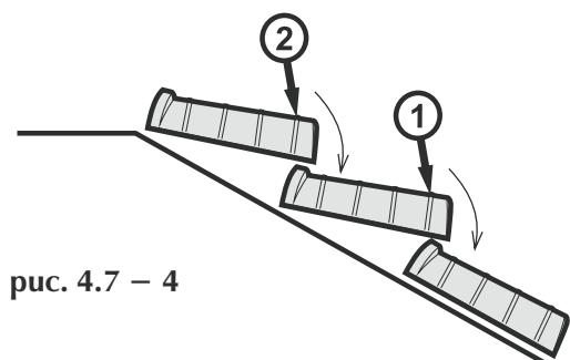
Перед монтажом вальмовых коньков дополнительно уложите уплотнители. Уплотнители ставятся вдоль бруса конька. Дальнейшее крепление вальмовых коньков производится аналогично креплению обычного конька. Укладывают полуциркульные коньковые элементы, как показано на Рис. 4.7 – 4.
