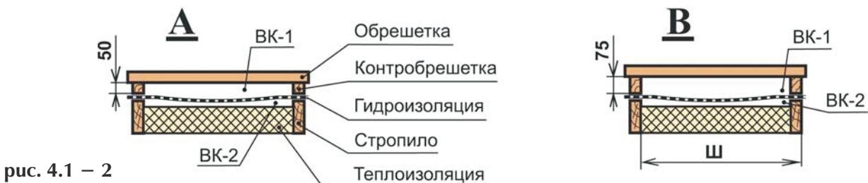
Если угол уклона кровли составляет менее 20°, контробрешетка выполняется из брусков сечением 50x75 мм для увеличения сечения вентиляционного канала ВК–1 Рис. 4.1 – 2 – В.
