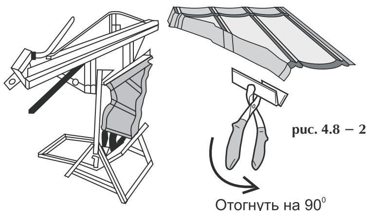
Перед монтажом, боковой край кровельного листа можно отогнуть вниз при помощи ручного или специального гибочного приспособления Рис. 4.8 – 2. Расстояние между нижним отгибом и элементом ендовы должно составлять 10–15 мм.
