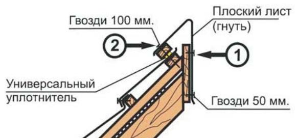
Для предотвращения попадания снега и влаги между коньковым бруском и коньковым элементом можно уложить универсальный уплотнитель.
