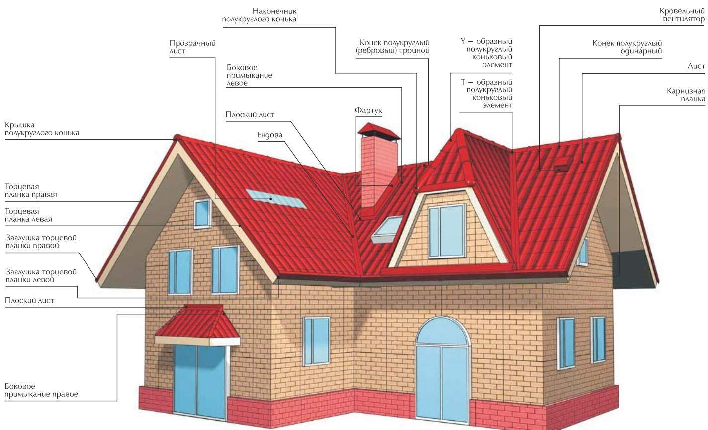
Этот схематичный чертеж дает Вам общее представление об основных элементах кровли и о местах установки большинства аксессуаров MetroTile®.
