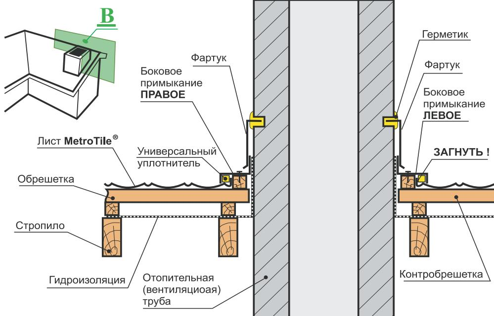
На Рис. 4.9 – 2 показан разрез отопительной (вентиляционной) трубы в плоскости В, перпендикулярной стропилам.
