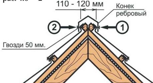
Коньковые элементы крепятся гвоздями к верхним брускам обрешетки (Рис. 4.6 – 1 и Рис. 4.6 – 2). Если кровля односкатная, конек выполняется согласно Рис. 4.6 – 4. Плоский лист изготавливается согласно уклону кровли и толщине стропил. Полукруглые коньковые элементы укладываются, как показано на Рис. 4.6 – 3.
