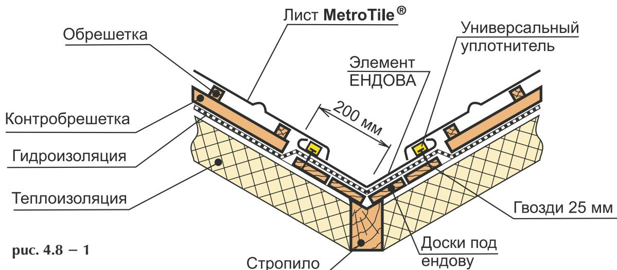
Гидроизоляция, смонтированная по скатам укладывается поверх гидроизоляции уложенной вдоль ендовы с нахлестом не менее 150 мм.
