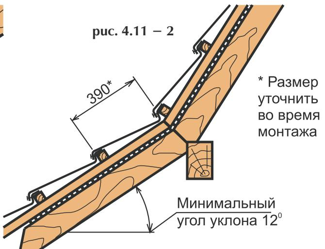
\* Размер зависит от угла уклона скатов и уточняется в процессе монтажа обрешетки.
